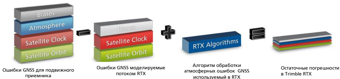
Рисунок 8. Моделирование ошибок в Trimble RTX
